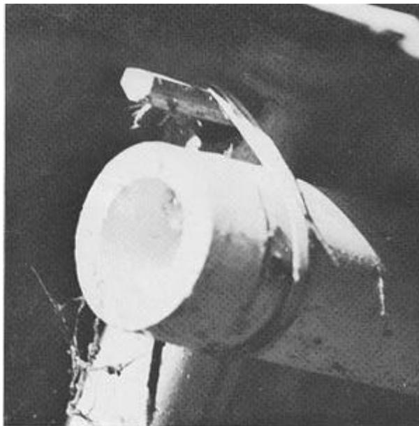
Rohrverbindung mit Steckplatte
